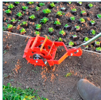
Nyhet! Cylinderrensare. Denna smidiga (knappt 10 kg) ogräsrensare består av ett hjul med ett bakomliggande skär. Kan justeras i höjdd. Finns i 120, 180 mm samt en dubbel variant som gränslar raden.
