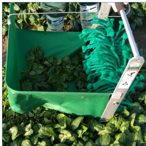
Smidigt handredskap för skörd av småblad som spenat och rucola. Drivs av din egna bormaskin! För mer info se www.semenco.se
