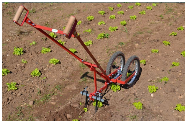
Bild 2. Terratecks tvåhjulshacka. Här monterad med två L-formade skyffelfjärr.
